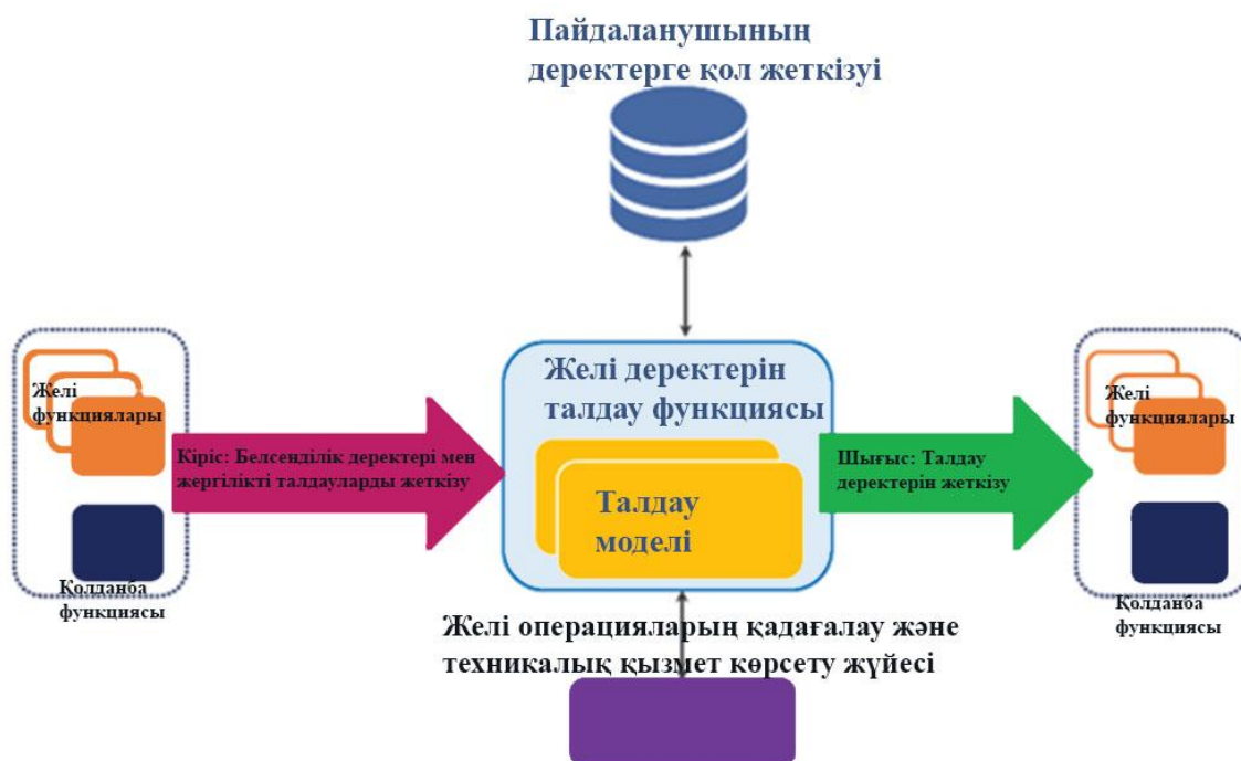
1.2-сурет – Желілік деректерді интеллектуалды талдау функциясының архитектурасы.
